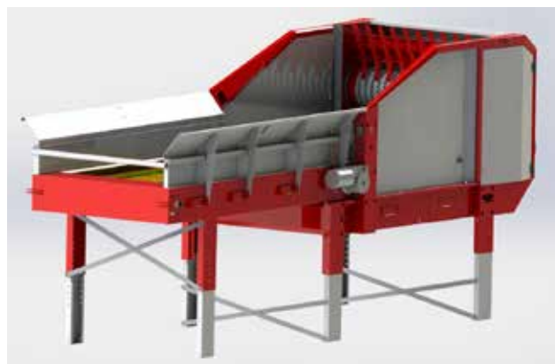
Figur 6: FlexiFeed med integrert kort matebord. FlexiFeed har avstivningsstag nede på beinsettene og matebordet har avstivningsstag oppe på beinsettet. Dersom matebordet har flere seksjoner monteres de påfølgende avstivningsstagene som det bakre på figuren.
