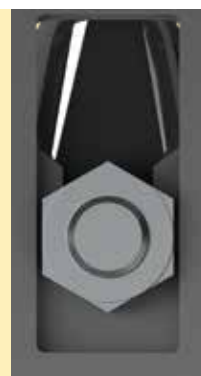
Figur 13: Fra innsiden av trommelen, mutter har mothold i sporet.
