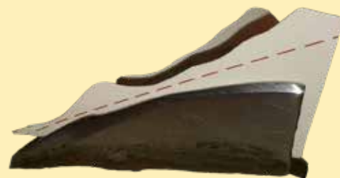
Figur 22: Utslitt kniv med knivmal. Kniven skal byttes når kniveggen er lavere enn den stiplede linjen.
