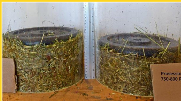
Sammenligning av kompresjonsgrad. Slept snitter til venstre mot lessevognen til høyre.
