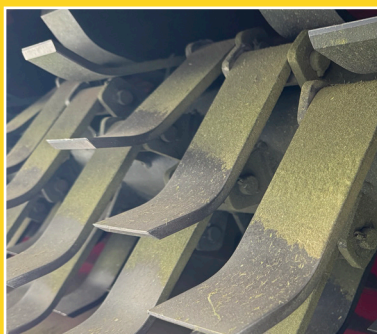
Hardox sliteplater i rotorhus
